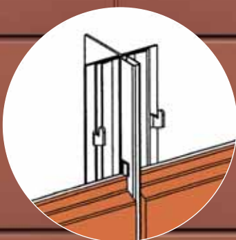
DETAIL – GESCHLOSSENE FUGE FUGE 9 MM BREIT
