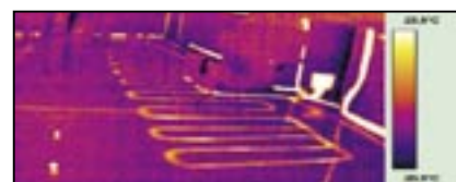
Slika 9: poškodba cevi talnega ogrevanja.
