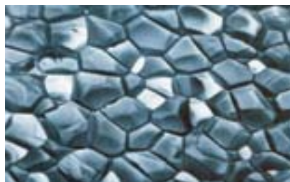
Slika 1: Tipična struktura zaprtih celic pene Styrofoam XPS (Fotografija: Dow Building Solutions)
