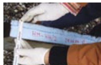
Slika 13: Plošča ROOFMATE ima po dvaintridesetih letih vgrajenosti enakomerno debelino 60 mm in je ohranila svojo obliko.
